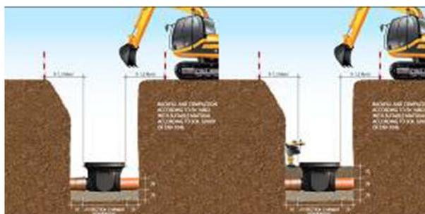
9.) Se il pozzetto è stato consegnato ad elementi, la base presenta un anello di rinforzo che serve ad evitare l'ovalizzazione durante la posa e compattazione. Questo anello dovrà essere rimosso con l'ausilio di un seghetto alternativo seguendo l'apposita linea di taglio stampata. Dopo aver effettuato il taglio eliminare le sbavature con apposito raschietto e ricreare lo smusso.
