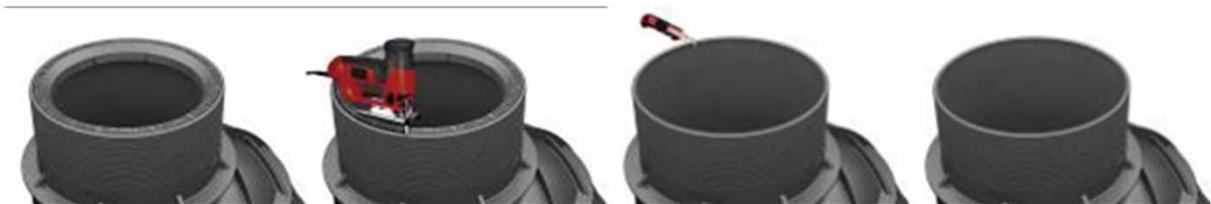
14.) Qualora l' elemento terminale debba essere accorciato, utilizzare un seghetto alternativo seguendo le apposite linee di taglio stampate ogni centimetro. Dopo aver effettuato il taglio eliminare le sbavature con apposito raschietto.
