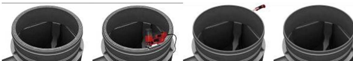
10.) Inserire la guarnizione di collegamento assicurandosi che le superfici siano perfettamente pulite. Controllare che i lembi della guarnizione siano perfettamente stesi, sia internamente che esternamente. Non utilizzare lubrificanti in questa fase, potrebbero far sfilare la guarnizione nella successiva fase.
